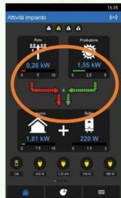
Fig. 6: App "Elios4you" mostra l'energia autoconsumata e prelevata dalla funzione "Boost"
