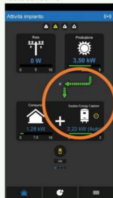
Fig. 4: App "Elios4you" mostra l'energia autoconsumata per scaldare l'acqua con il puffer
